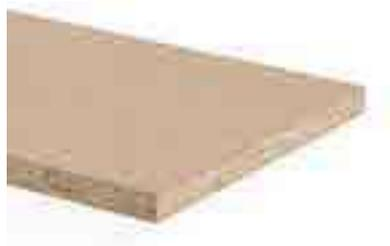
Pannello truciolare di legno tipo P4 secondo la norma EN 312, per uso portante in ambienti asciutti, incollato al 100 % senza formaldeide.
