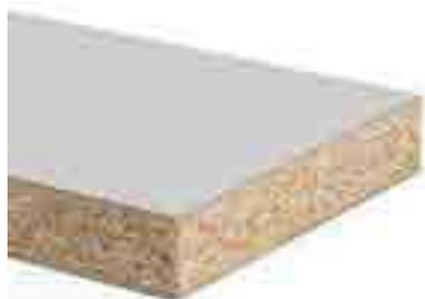
Piano da lavoro composto da un pannello truciolare tipo P2 come da norma EN 312, rivestito un lato con Duropal HPL, Duropal XTreme, Duropal XTreme Touch o Duropal XTreme plus. Il lato inferiore é costituito da una controbilanciatura idrorepellente. I bordi longitudinali sono fresati. Disponibile anche nella variante con un bordo protettivo su un lato. Duropal XTreme, Duropal XTreme Touch così come Duropal XTreme plus sono un'attraente superficie decorativa super opaca con effetto anti-finger.
