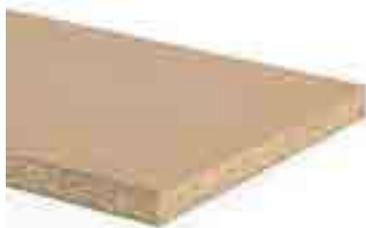
PremiumBoard MFP Hybrid è costituito da un'anima centrale in PremiumBoard MFP Living P5 e copertine HDF dello spessore di 2 mm nobilitati su entrambi i lati. L'incollaggio tra MFP e HDF avviene con colla PVAC (D4). Grazie alla resistenza alla flessione isotropa, all'elevata resistenza all'estrazione delle viti e alla buona stabilità dimensionale, questo pannello ibrido è ideale soprattutto per le applicazioni dove è richiesta stabilità e resistenza.
